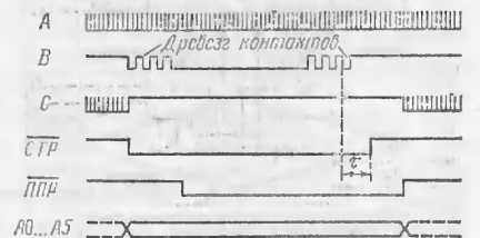
Рис. 2. Временные диаграммы работы клавишного пульта
